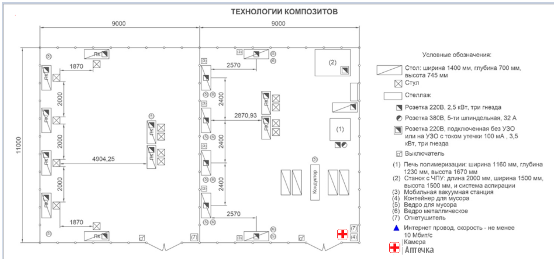
Рисунок II.1 - План застройки площадки центра проведения демонстрационного экзамена
